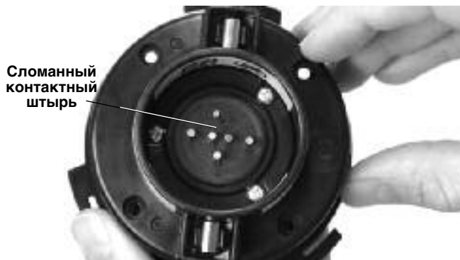
Рис. 7. Сломанный контактный штырь
