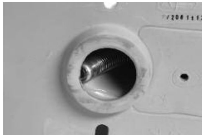
Рис. 20. Головка камеры заблокирована на повороте
